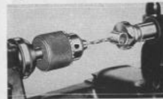
Fig. 188. Percage d'un Trou de Graissage sur une Douille avec un Plateau à Rainure
