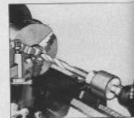
Fig. 160. Mandrin de Foret monté sur Canon de Contrepointe
