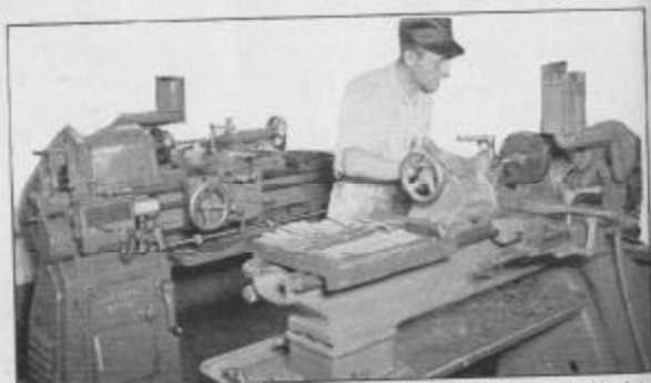
Fig. 309. Fonctionnement de deux Tours avec Butées Automatiques de Chariot, conduits par un seul Tourneur
