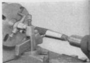
Fig. 176. Usinage d'un Cône par Déplacement de la Partie Supérieure de la Contrepointe
