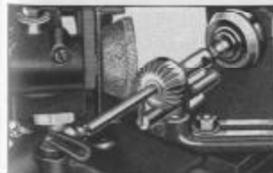
Fig. 321. Meulage d'une Fraise au Tour
