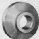
Fig. 346. Faux-Plateau Semi-Usiné, Fileté pour s'ajuster au Nez de la Broche
