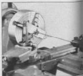
Fig. 153. Centrage d'une Pièce avec un Indicateur de Centre
