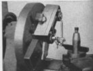
Fig. 264. Manière de Centrer la Pièce sur le Plateau avec un Indicateur à Cadran
