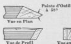
Fig. 74. Détail de l'Outil pour Surfacier à Droite
