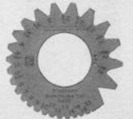
Fig. 216. Calibre Multiple pour l'Affûtage des Outils à Fileter
