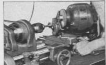
Fig. 331. Rectification d'une Soupape par Moulage
