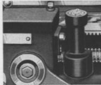
Fig. 236. Indicateur à Cadran pour Filetage Fixé au Chariot du Tour
