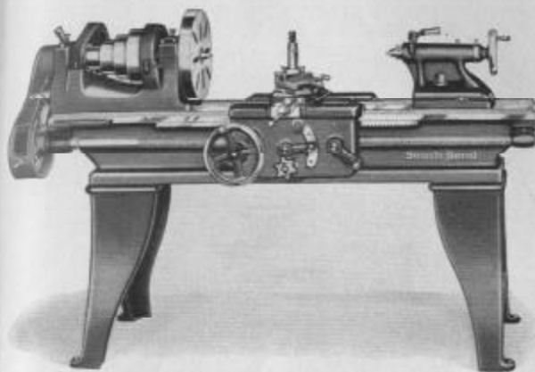
Fig. 5. Un Tour Moderne à Changement d'Engrenages Standard
