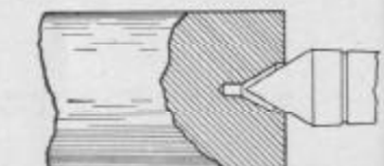
Fig. 128. Trou de centre inexact, foré trop profondément pour s'adapter à la pointe
