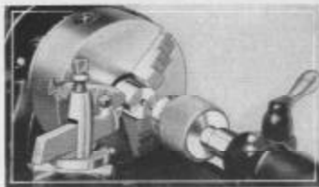
Fig. 125. Forage d'un trou de centre sur une pièce montée dans un mandrin de tour, avec une meche maintenue dans le mandrin du canon de la contrepointe
