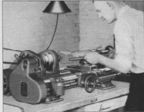
Fig. 341. Tournage du Bois sur un petit Tour à travailler le Métal
