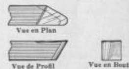
Fig. 70. Détail de l'outil à tourner à coupe de la droite
