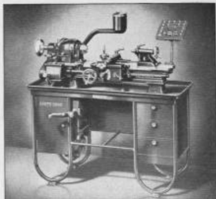
Fig. 323. Le Tour d'Établi 10 Ponces avec Passage en Pince de 25,4 m/m
