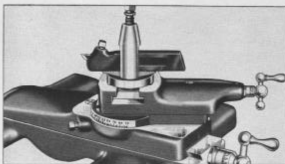
Fig. 221. Chariot Pivotant Placé à un Angle de 29° pour le Filetage
