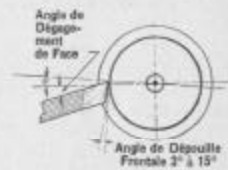
Fig. 56. Angle de Dépose Frontale et Angle de Dégagement de Face corrects de la Lame
