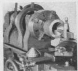
Fig. 171. Usinage d'un Poinçon et d'une Matrice Coniques avec le Chariot Pivotant
