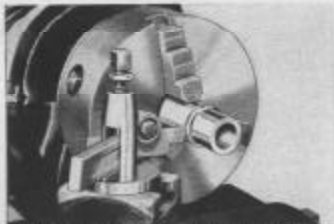
Fig. 328. Fabrication d'une Douille de Rechange sur un Tour de 9 Pouces
