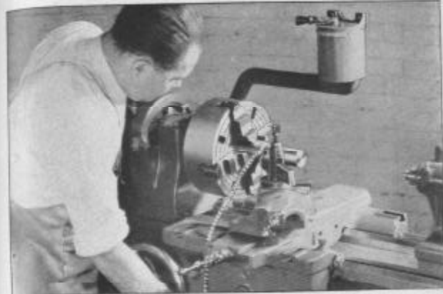
Fig. 148. Usinage d'un Arbre dans le Mandrin Indépendant
