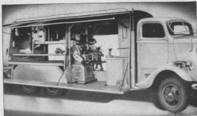
Fig. 338 représente un atelier transportable installé dans un grand camion
