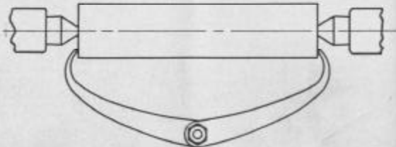
Fig. 147. Mesurage de la Longueur d'un Arbre avec un Compas d'Épaisseur à Joint Ferme
