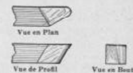
Fig. 72. Détail de l'outil à tourner à coupe de la gauche
