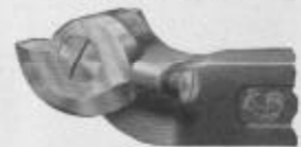
Fig. 215. Outil à Fileter à Profil Constant
