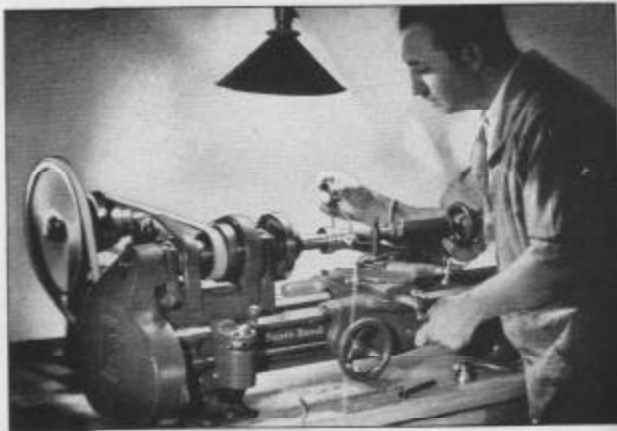
Fig. 339. Tournage du Métal sur un petit Tour à Fileter à Harnais d'Engrenages
