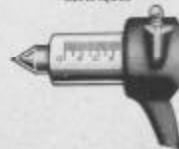
Fig. 314. Graduons Métriques sur la Broche de Contrepointe
