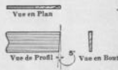
Fig. 82. Détail de l'Outil à Tronçonner
