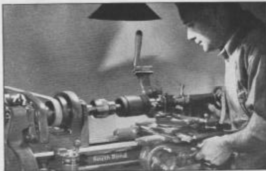
Fig. 327. Rectification et Dégagement d'un Collecteur d'Induit au Tour
