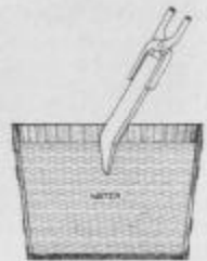
Fig. 349. Trempe d'un Outil de Tour
