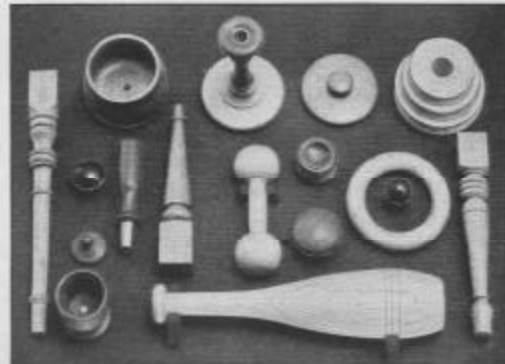
Fig. 342. Pièces en Bois et en Fibre tournées sur un petit Tour à travailler le Métal
