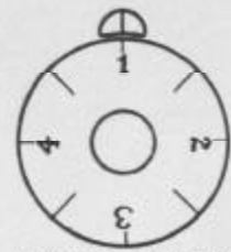
Fig. 237. Face de l'Indicateur à Cadran pour Filetage
