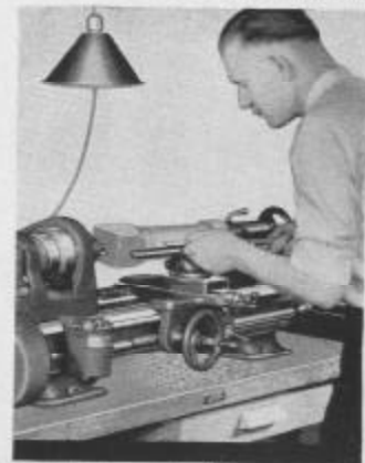
Fig. 307. Tournage du Bois sur un Tour à Travailler les Métaux
