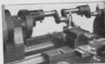
Fig. 335. Vilebrequin monté sur le Tour pour le tournage d'un Maneton
