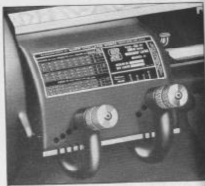
Fig. 211. Mécanisme de Changement d'Engrenages Rapide pour Filetage.
