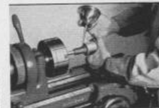
Fig. 267. Rodage de l'intérieur d'une Douille d'Acier Trempé, avec Poussière d'Emeri et Huile
