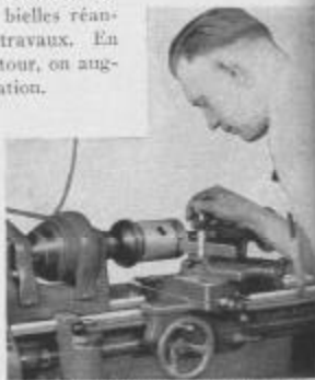
Fig. 329. Finition sur un Tour de 9 Pouces d'un Piston Semi-Ulné
