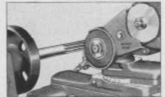
Fig. 322. Meulage d'un Alésoir Cylindrique au Tour
