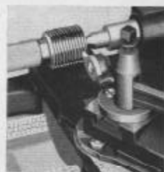
Fig. 222. Filetage avec le Chariot Pivotant Placé à 29°
