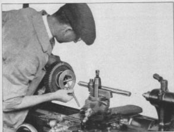
Fig. 112. Emploi d'une Jauge Micrométrique pour Mesurer le Diamètre d'un Trou en cours d'Alésage
