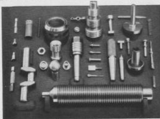
Fig. 340. Pièces en Métal entièrement usinées sur un Tour de Précision de 9 Pouces (235 m/m) à Fileter à Harnais d'Engrenages
