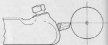
Fig. 52. Arête Coupante de la Lame exactement au Centre pour Filetage, Tournage de Cônes, Usinage du Laiton, du Cuivre, etc.
