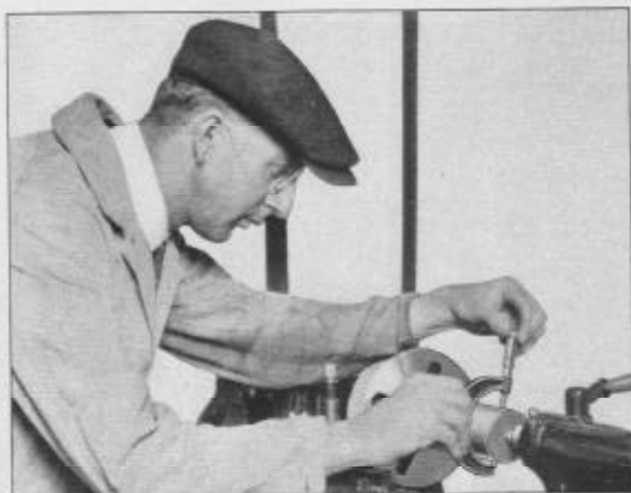
Fig. 111. Emploi d'un Micromètre pour Mesurer un Travail sur le Tour
