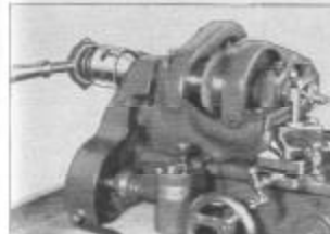
Fig. 291. Dispositif de Pince Américaine à Levier à Main
