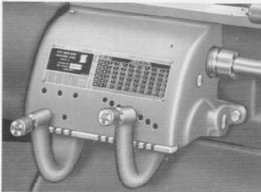
Fig. 7. Caja moderna con engranajes de cambio rápido
