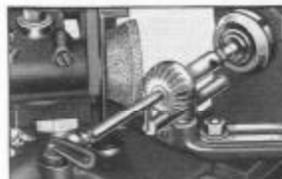
Fig. 321. Esmerilado de una fresa angular en el torno
