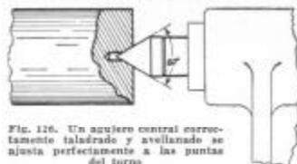
Fig. 126. Un agujero central correctamente taladrado y avellanado se ajusta perfectamente a las puntas del torno.
