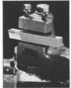
Fig. 88. Cuchilla con calza de tungsteno carburado montada en un poste para herramientas con lado abierto para aprete rígido.
