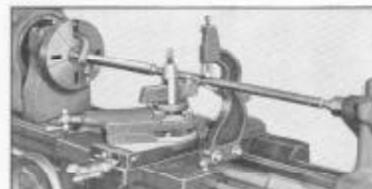
Fig. 285. A la izquierda—Fileteado de una pieza delgada y larga con ayuda de la luneta móvil
