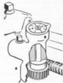
Fig. 237. Indicador de carátula para filetear colocado en el carro del torno
