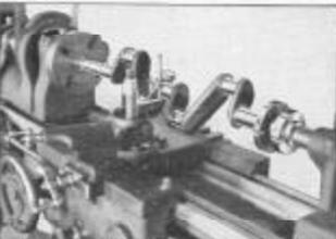
Fig. 337. Comprobación de un cigüeñal en el torno
