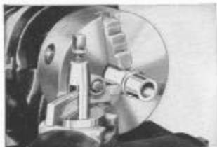
Fig. 328. Rectura de un buje de repuesto en un torno de 229 mm
