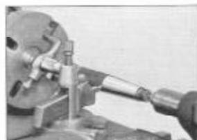
Fig. 176. Labrado cónico con la contrapunta descentrada
