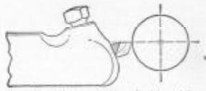
Fig. 217. Parte superior de la cuchilla colocada en el centro para abrir roscas
