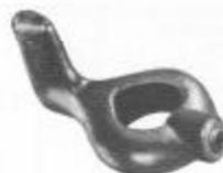
Fig. 130. Perro de Seguridad para Torno.
