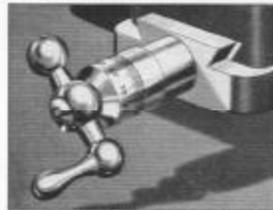
Fig. 35-A. Anillo micrométrico en el avance transversal
