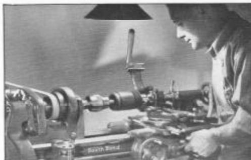
Fig. 327. Rectificación y ranurado de un conmutador de inducido en el torno
