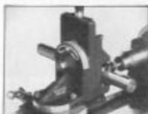
Fig. 299. Fresado de una ranura Woodruff para chaveta en una flecha
