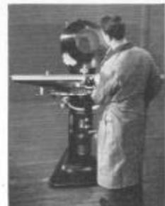
Fig. 110. Un comparador óptico
