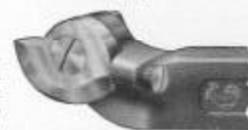
Fig. 215. Herramienta para filetear, tipo sólido, con sección transversal uniforme
