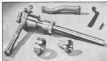
Fig. 169. Aditamento de mandril de boquillas con barra tractora de palanca a mano
