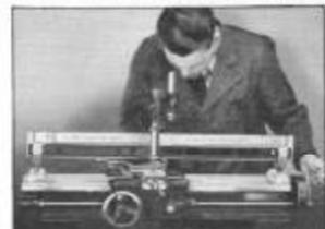
Fig. 110-A. Comprobando la exactitud de un tornillo principal
